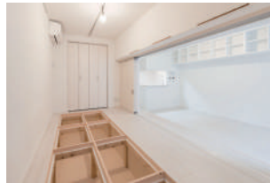
〈逆梁工法を利用した床下収納〉
